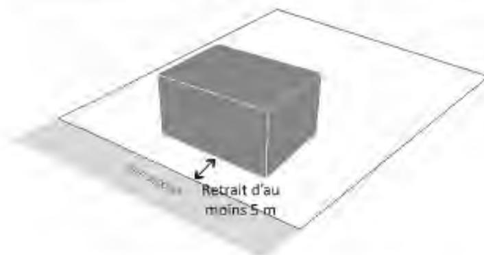
FIGURE 17\_ Retrait minimum vis-à-vis de l'alignement
