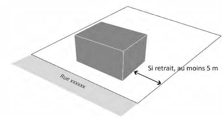
FIGURE 12\_ En cas de retrait, recul minimum vis-à-vis des limites séparatives
