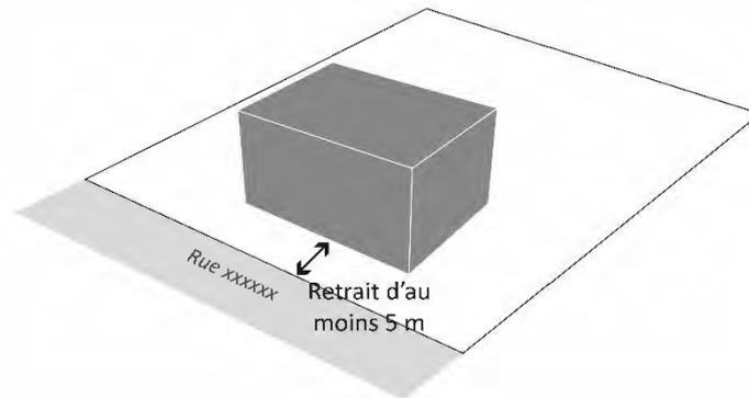
FIGURE 17\_ Retrait minimum vis-à-vis de l'alignement
