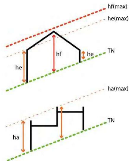
Figure 20 Principe de calcul de la hauteur (avec TN le terrain naturel avant travaux, he la hauteur à l'égout, hf la hauteur au faîtage, ha la hauteur à l'acrotère et hmax la hauteur référence du PLUiH)
