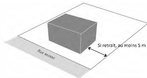
FIGURE 19\_ En cas de retrait, recul minimum vis-à-vis des limites séparatives
